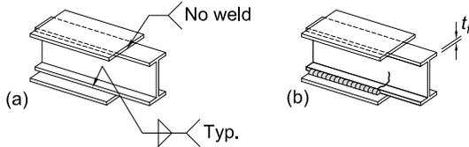
**SECTION 4—LONGITUDINAL FILLET WELDED END CONNECTIONS**
